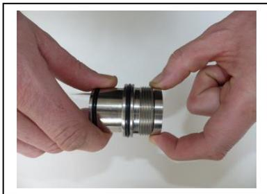
Schieben Sie nun den Glaskolben bis zum Ende der Gewindemutter. Weitere Schritte siehe unter Einbau in den EVO 3 Filter.
