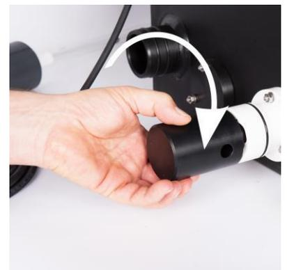
Schieben Sie die Demontagehilfe bis zum Anschlag in den weißen Flansch. Verschrauben Sie gemäß Abbildung die Demontagehilfe.
