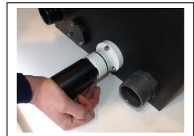
Verschrauben Sie die Montagehilfe mit dem vorher montierte Hüllrohr. Führen Sie das Hüllrohr in den Aufnahmeflansch und drücken sie dieses bis zum Anschlag in den Filter.
