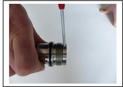
Führen Sie die Aufnehmerbuchse zur Gewindemutter und verschrauben Sie es miteinander. Damit das Verschrauben einfacher zu handhaben ist, verwenden Sie einen kleinen Schraubenzieher oder ähnliches. Führen Sie dazu den Schraubenzieher in die Aussparung der Gewindemutter und ziehen es fest.
