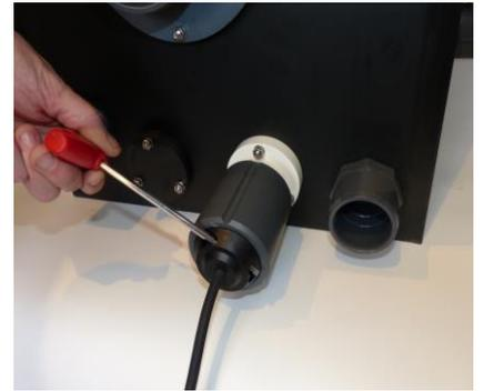
**Niemals im Eingeschalteten Zustand den Brenner ausbauen!** Drehen Sie den grauen Flansch gemäß Abbildung. Sollten Sie Probleme beim Drehen der Lampenfassung haben, verwenden Sie einen Schraubenzieher oder ähnliches und die dafür vorgesehene Aussparung. Ziehen Sie den Brenner aus der Fassung.
