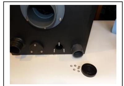
Stellen Sie sicher, dass der Filter entleert ist. Entfernen Sie die 3 Muttern und Unterlegscheiben der am Filter vormontierten Blindkappe. Die Schrauben (Gewindestangen) sind fest mit dem Filter verbunden und nicht abnehmbar. Bewahren Sie die drei Muttern und Unterlegscheiben für die weitere Montage auf. **Bitte bewahren Sie ebenfalls den Blinddeckel auf, damit bei Wartungsarbeiten die UVC Öffnung wieder verschlossen werden kann.**
