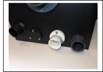
Vergewissern Sie sich, dass die Dichtung auf dem Flansch sitzt und schieben Sie nun den Aufnahmenflansch über die Gewindestangen in den Filter. Befestigen Sie mit den drei, eben abgeschraubten Muttern zzgl Unterlegscheiben, den Flansch. Achtung! Ziehen Sie die Muttern nicht zu fest an.
