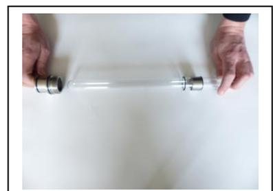
Schieben Sie die O-Ringe und die Distanzhülse auf das Quarzglas. Ziehen Sie von oben die Aufnahmebuchse bis zum Ende des Hüllrohres.
