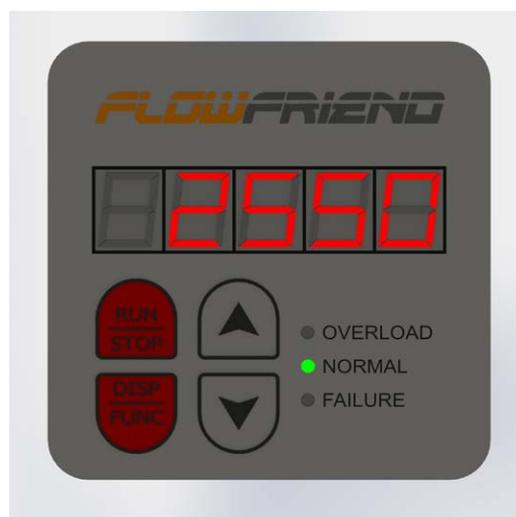
Verwenden Sie diese Taste, um den Betriebsmodus zu ändern. Während der Motor läuft, wird auf dem Display die aktuelle Geschwindigkeit angezeigt. Wenn der Motor abgeschaltet wird, erscheint auf dem Display '0'.
