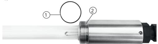
Auch den 25 x 1 mm O-Ring (1), welcher sich auf dem Gewinde der Hülse (2) befindet, durch einen neuen ersetzen.
