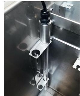
Je nach Montageort der UVC-Halterung kann es bei einigen Filtermodellen notwendig sein, die Mutter der Gasdruckdämpfer zu lösen um den UVC-Strahler in die Halterung einsetzen zu können.
