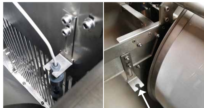
BioKompakt-Modelle: Reinwasserbereich außerhalb der Trommel Filter ohne Biokammer: Schwimmerschalter hier montieren. Reinwasserbereich außerhalb der Trommel
