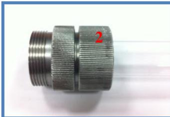
Sichern Sie das Quarzglas mit der beiliegenden Überwurfmutter (2). Ziehen Sie die Mutter nur handfest an. Im Auslieferungszustand werden alle Gewinde geschmiert. Achten Sie darauf, dass kein Schmierstoff, auf die Gummidichtungen, oder das Quarzglas gelangt.
