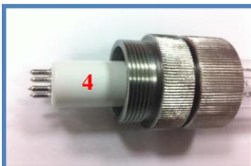
Nun schieben Sie die UVC Lampe (4) in die Quarzröhre. Achten Sie darauf, die Lampe gerade einzuführen. Bei dieser Länge genügt wenig Kraft, um das Quarzglas durch die entstehende Hebelwirkung zu zerbrechen. Der Lampenstecker passt nur in zwei Positionen.
