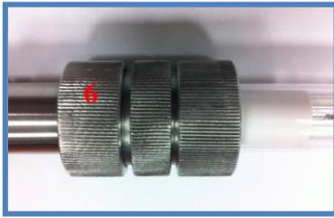
Ziehen Sie nun die zweite Mutter (6) handfest an. Übermäßige Kraftanwendung an der Spannschraube (Überwurfmutter) hat keinen großen Einfluss auf die Dichtigkeit des Gehäuses und kann mechanische Schäden am Quarzrohr verursachen.
