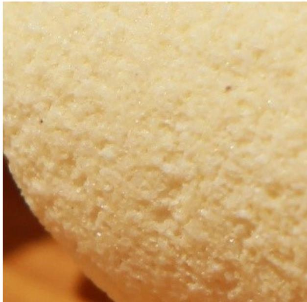
Sowohl offene als auch geschlossene Poren ermöglichen die Kultivierung von aeroben und anaeroben Bakterien, die effektiv Nitrit in Nitrat umwandeln.
